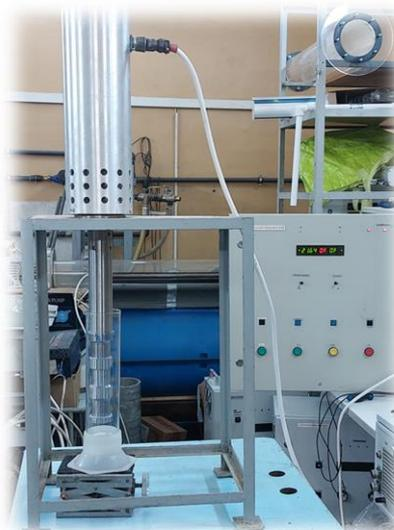
УЗ-установка для гомогенизации суспензий (ИОНХ РАН) 700 Вт
