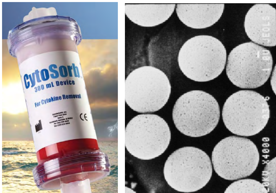
Рис. 6.5. Колонка CytoSorb и гранулы полидивинилбензола
