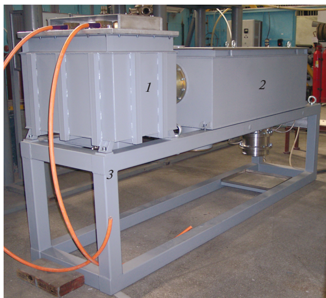
Рис. 13. Внешний вид высоковольтного блока. 1 – блок в.в.-трансформатора; 2 – блок высоковольтного емкостного накопителя; 3 – рама.
