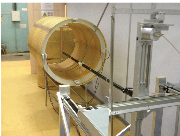
Рис. 17. Макет катушки градиентно-корректирующего модуля.
