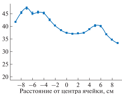
Рис. 3. Результаты измерений большой сцинтилляционной ячейки, покрытой отражателем TYVEK (а) и диффузионным отражателем (б): слева — зависимость светового выхода от точки прохождения пучка по диагонали детектора; справа — гистограмма распределения светового выхода по всем измеренным точкам ячейки.
