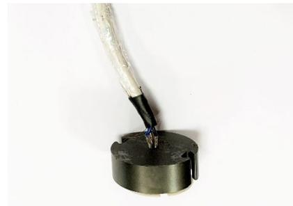
Рис. 5. Внешний вид преобразователя.
