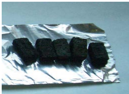
Рис. 2. Внешний вид образцов после нанесения покрытия металлического никеля на пенокорунд.
