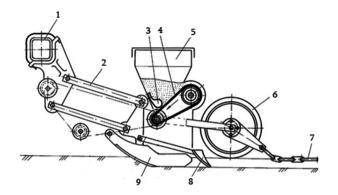
Рис.1. Схема сеялки с пневматическим высевающим аппаратом для совмещенного высева семян нескольких культур: 1 — рама сеялки; 2 — параллелограммный механизм подвески; 3 — заслонка; 4 — цепная передача; 5 — бункер для семян с высевающим аппаратом; 6 — прикатывающее колесо; 7 — шлейф; 8 — загортач; 9 — полозовидный сошник.
