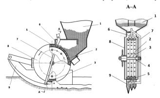
Рис. 2. Пневматический высевающий аппарат для совмещенного высева семян нескольких культур: 1 — бункер для семян; 2 — ось; 3 — составной высевающий диск; 4 — прижимающая втулка; 5 — ячейка высевающего диска; 6 и 7 — патрубки; 8 — крышка высевающего аппарата; 9 — составной сошник.
