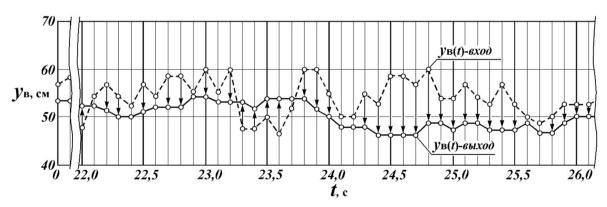
Рис. 4. Фрагмент реализации процесса выравнивания ленты льна в ВУ подборщика-очесывателя ПОЛ-1,5К.
