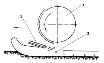
Рис. 4. Схема транспортировки семян в борозду: 1 — высевающий диск; 2 — семя; 3 — дополнительный патрубок под высевающим диском вакуумного высевающего annapama.
