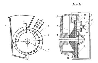
Рис. 3. Макетный образец высевающего аппарата, работающего на вакууме: 1 — бункер для семян; 2 — камера разрежения; 3 — приемная семенная камера; 4 — ось; 5 — высевающий диск; 6 — отверстие; 7 — ворошилка семян; 8 — вентилятор; 9 — патрубок; 10 — нагнетающий патрубок; 11 и 12 — рукава.
