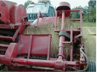
Рис. 2. Подборщик-очесыватель ПОЛ-1,5К в работе: а) вид спереди; б) процесс выравнивания ленты льна.
