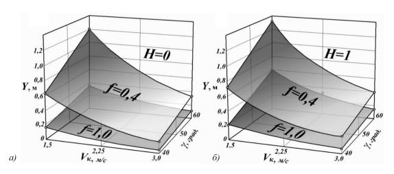
Рис. 3. Зависимость смещения стеблей от исследуемых факторов: а) применение колкового транспортера; б) транспортирующий конвейер вся поверхность стола ВУ.
