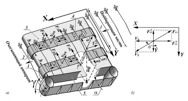
Рис. 1. Выравнивающее устройство: 1 — конвейер транспортирующий, комлевой; 2 — конвейер транспортирующий, вершинный; 3 — стол; 4 — лопасти; 5 — конвейер выравнивающий; a — распределение сил, действующих на растение; b0) распределение скоростей движения растения по поверхности стола b1 ( $V_{\kappa}$  — скорость конвейеров b1 1 2;  $V_{\kappa}$  — проекция скорости растения  $v_{p}$  на ось  $v_{p}$ 1  $v_{n}$ 2 – силы воздействия лопастей вершинного и комлевого конвейеров на растение).
