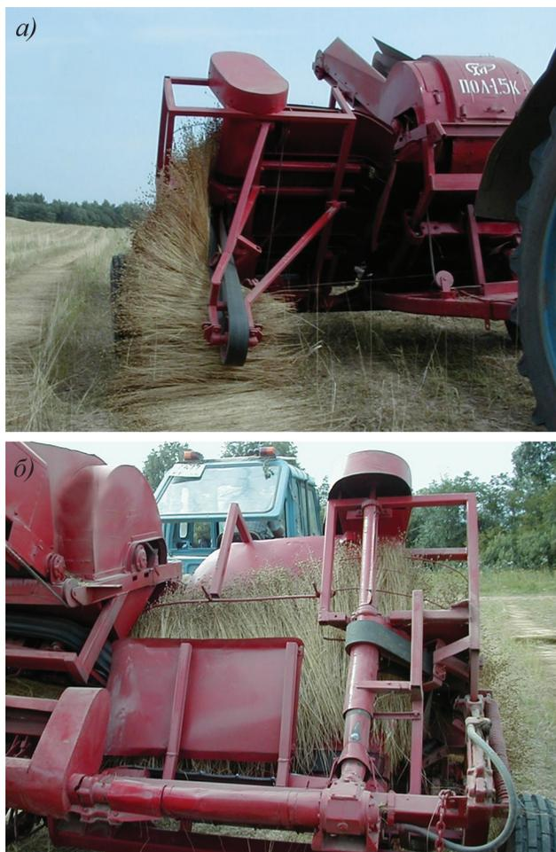
Рис. 2. Подборщик-очесыватель ПОЛ-1,5К в работе: а) вид спереди; б) процесс выравнивания ленты льна.
