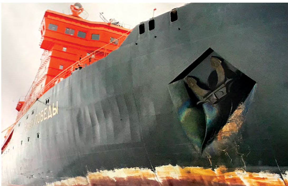
Рис. 8.5. Вмятина в борту атомного ледокола «50 лет Победы» от столкновения с айсбергом
