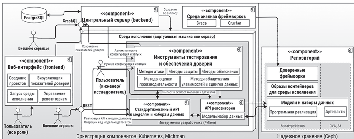
Рис. 2. Высокоуровневая архитектура Платформы.
