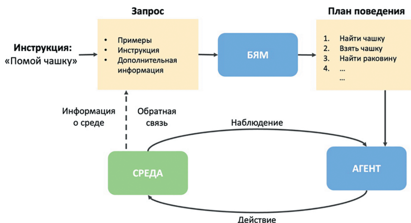
Рис. 1. Общая архитектура использования больших языковых моделей (БЯМ) для задачи построения плана поведения воплощенного агента.
