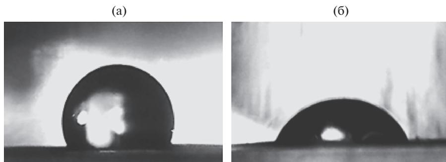
**Рис. 2.** Фотография капли (вода) на исходной поверхности пленки ПТФЭ (а) и на поверхности пленки модифицированной в плазме ТРАД (б). Толщина пленки  $d = 60$  мкм.
