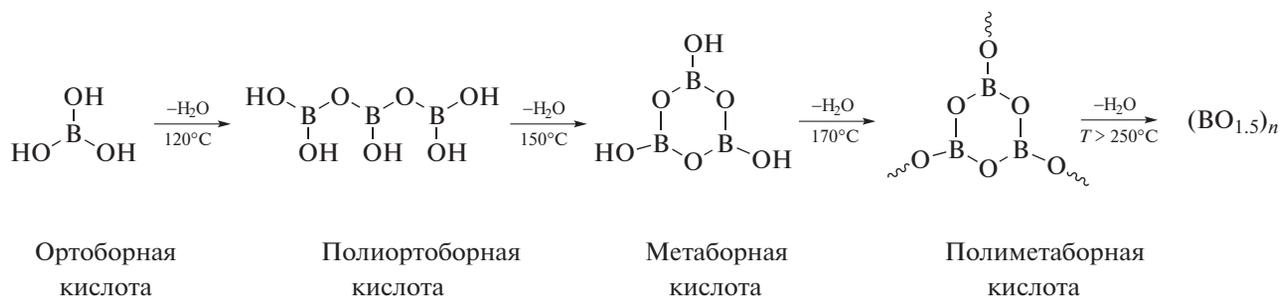
По данным ДСК этот процесс сопровождается эндотермическим эффектом и при этом происходит уменьшение массы образцов. В этой связи представляло интерес исследовать влияние пластического деформирования под высоким давлением на тепловые процессы в смесях БК–BN. Для сравнения были исследованы деформированные смеси БК с некоторыми полимерами и низкомолекулярными неорганическими соединениями, в частности, с алюминием.
