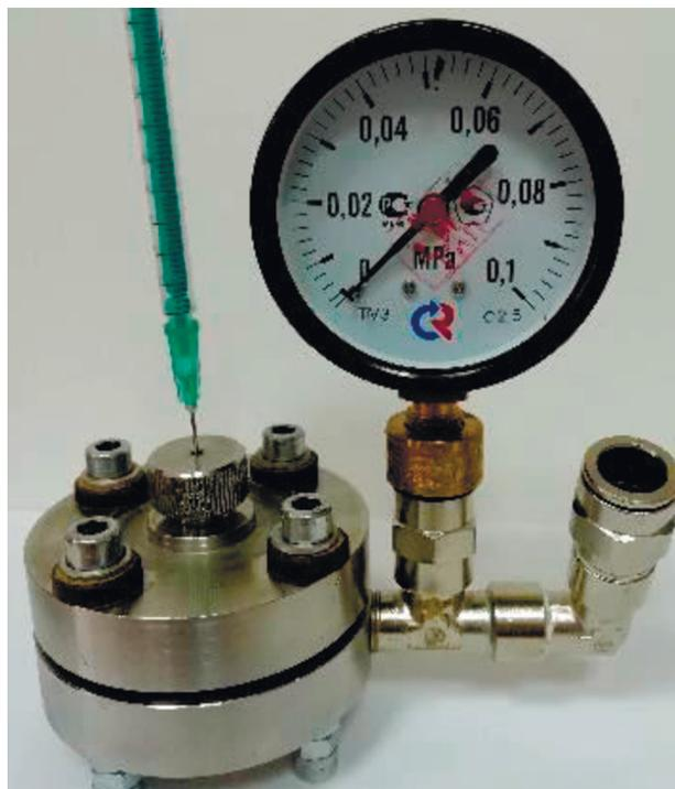
Рис. 2. Фото барометрической ячейки для определения электрохимически неактивного металлического лития.
