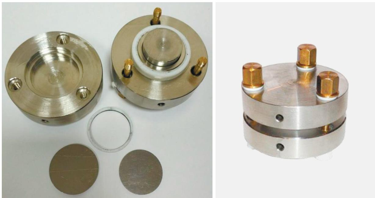
Рис. 1. Фото электрохимической ячейки Li|электролит, сепаратор|SS в разобранном (слева) и в собранном виде (справа).
