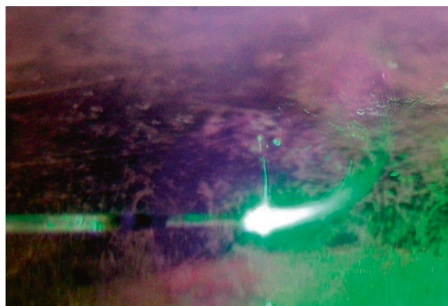
Рис. 1. Затопленная струя нагретой жидкости, распространяющаяся от торца оптоволоконного с диаметром по кварцу 0.6 мм, на который нанесён слой углерода, поглощающий лазерное излучение с длиной волны 0.97 мкм (подсветка зелёным излучением пилотного лазера)
