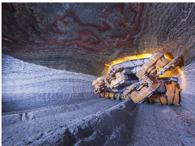
Рис. 2. Добычный комбайн с автономной системой навигации на калийном руднике
