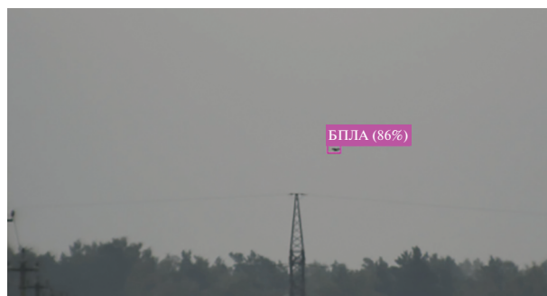
Рис. 9. Распознавание беспилотного объекта на расстоянии в 500 м с фокальным расстоянием объектива 114.5 мм.
