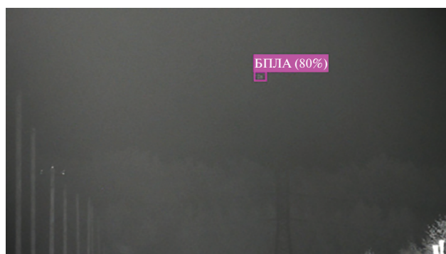
Рис. 11. Распознавание беспилотного объекта на расстоянии 500 м с фокальным расстоянием 114.5 мм в ИК-диапазоне на фоне неба в дождливую погоду.
