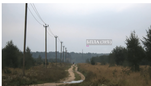
Рис. 10. Распознавание беспилотного объекта на расстоянии в 500 м с фокальным расстоянием 25 мм.
