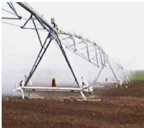
**Рис. 1.** Дождевальная машина “Кубань” с шагающими двигателями
