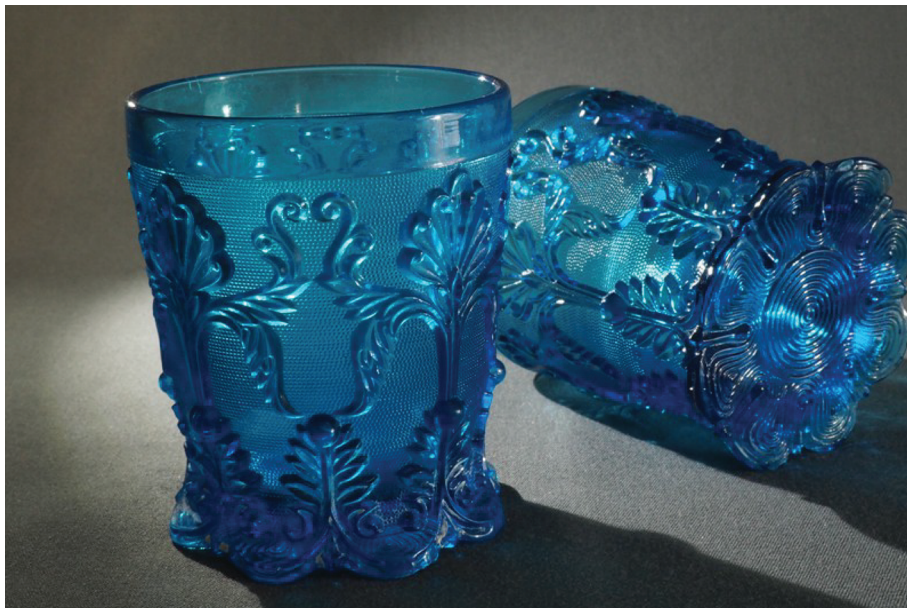
Рис. 7. Изделие из стекла, выполненное методом прессования.
