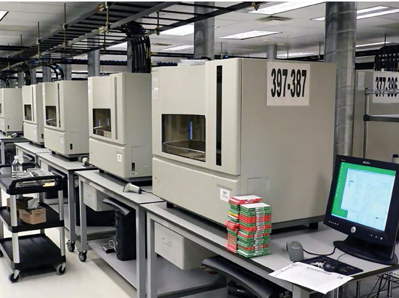
Секвенаторы — приборы, которые определяют последовательность нуклеотидов в цепи ДНК
