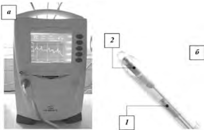
Рис.6. Оборудование для измерения МК методом термодиффузии: а – внешний вид прибора; б – паренхиматозный датчик с пассивным (1) и активным (2) термисторами.
