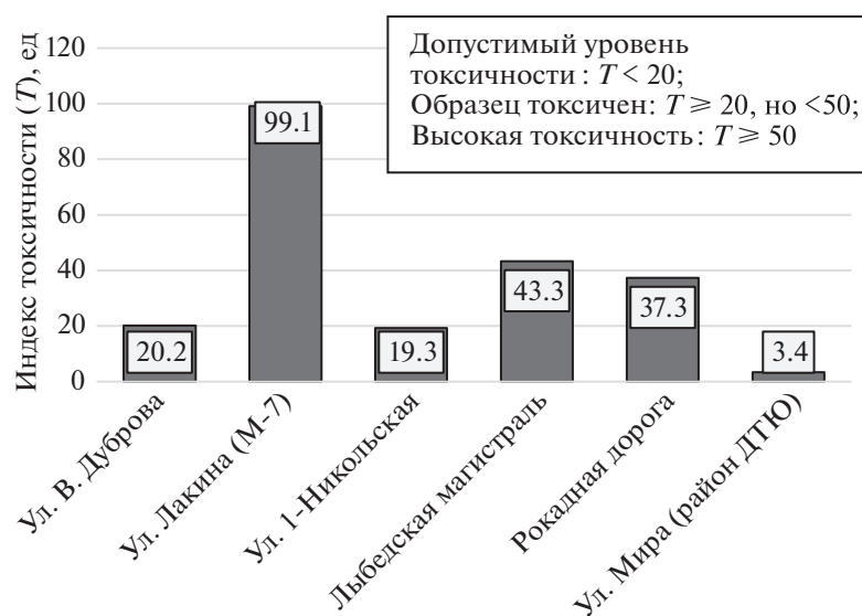
Рис. 3. Индекс токсичности отфильтрованных проб талой воды.
