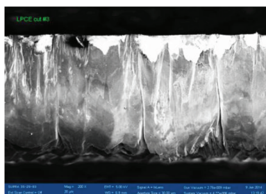
Рис. 4. Увеличенные кристаллиты после лазерной плазмохимической обработки.
