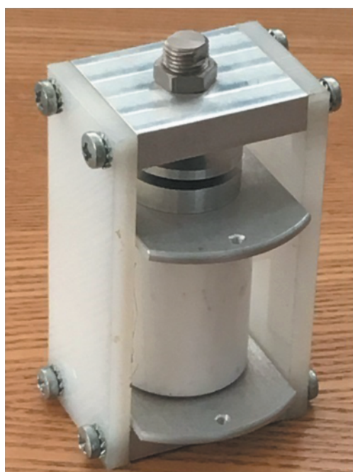
Рис. 2. Блок SID с рабочим напряжением 12 кВ.
