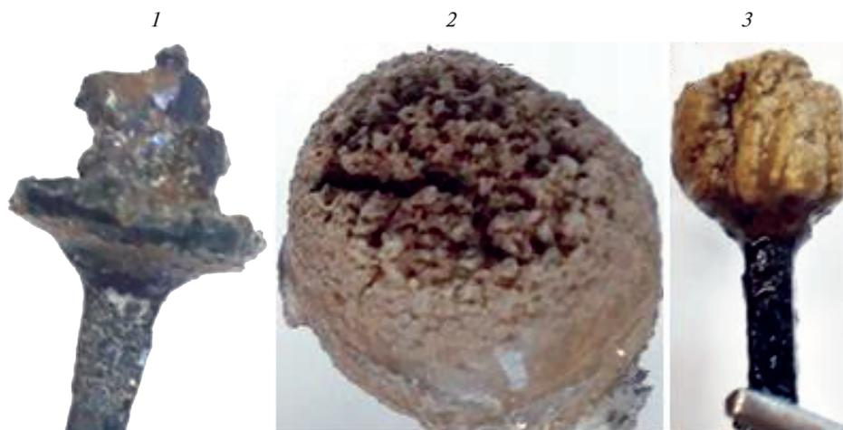
**Рис. 7.** Фотографии катодных осадков кремния, полученных при электролизе расплава  $KCl$  с 5 мас. %  $K_2SiF_6$  при температуре  $790^\circ C$  на стеклогуглероде при катодном перенапряжении 0.25 (1),  $-0.15$  (2) и  $-0.10$  (3) В.
