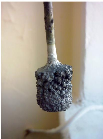
**Рис. 2.** Внешний вид карбидно-солевой “груши”, полученной электролизом расплава  $45\text{K}_2\text{CO}_3\text{--}45\text{Na}_2\text{CO}_3\text{--}1\text{Li}_2\text{CO}_3\text{--}9\text{Li}_2\text{MoO}_4$  (мол. %).  $T = 1023$  К. Плотность тока –  $2.0 \text{ A/cm}^2$ .
