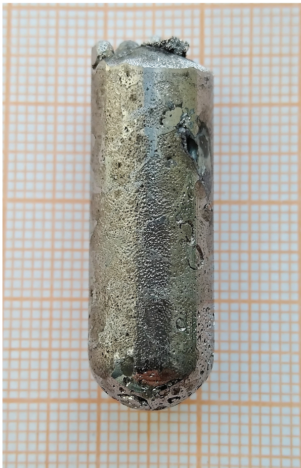
Рис. 1. Внешний вид слитка состава 80 мол. % \text{Cd}_{2.76}\text{Mn}_{0.24}\text{As}_2 –20 мол. % \text{MnAs} .
