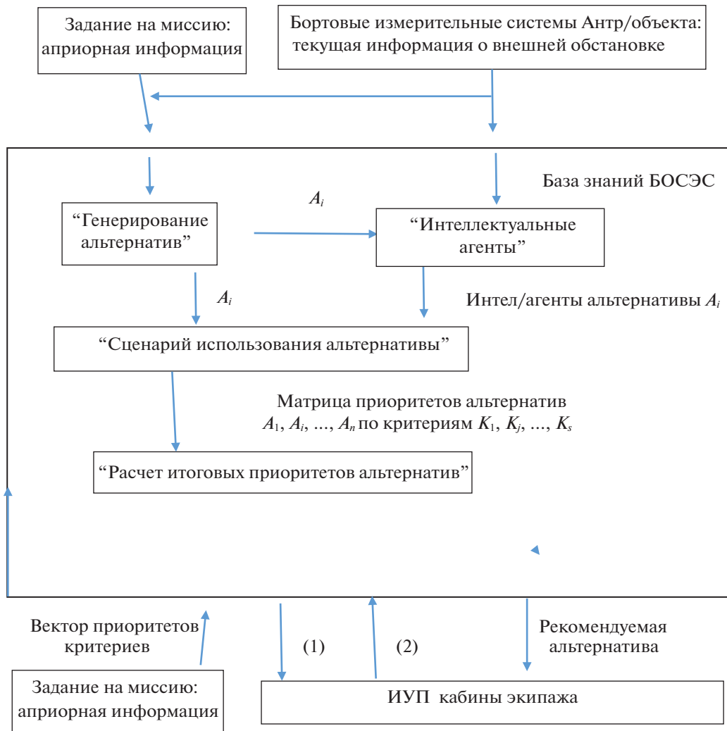
Рис. 1. База знаний БОСЭС (решение проблемы методом МКВА): (1) – транспарант оперативного конструирования экипажем вектора приоритетов критериев, (2) – скорректированный экипажем вектор приоритета критериев
