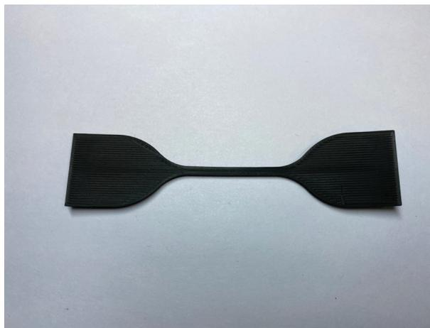
Рис. 4. Фотография лопатки, полученной методом FDM печати.
