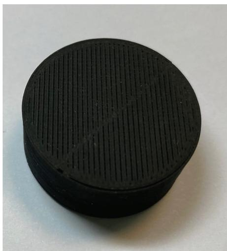
Рис. 5. Фотография цилиндра, полученного методом FDM печати.
