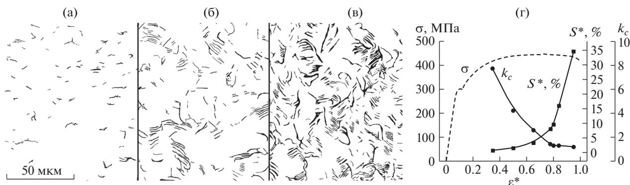
**Рис. 1.** Картины микротрещин в образце из стали 20 на разных этапах нагружения, соответствующие относительной деформации  $\varepsilon^*$  0.35 (а), 0.78 (б) и 0.95 (в) и деформационные зависимости напряжения (пунктирная кривая), площади пор и микротрещин на поверхности образца  $S^*$  и значений  $k_c$ -параметра (г) (по данным [13]).
