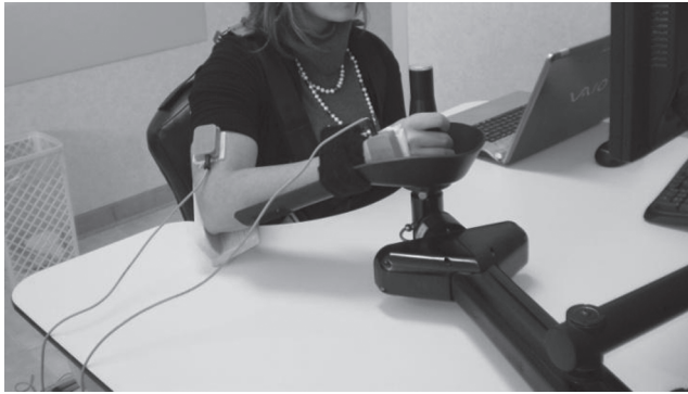
Рис. 2. Роботизированный тренажер MIT-Manus (США), управляемый сигналом пЭМГ.
