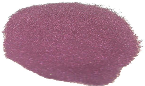
Рис. 2. Фотография полученного порошка гексаборида лантана.
