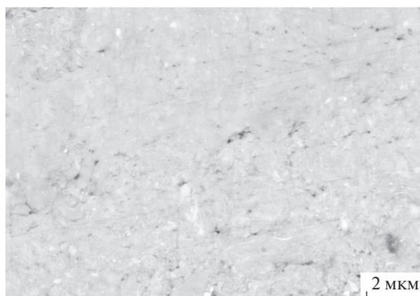
**Рис. 4.** Микроструктура сплава (СЭМ), полученного после ВЭМО смеси (TaZrHfNbTi) + C в течение 45 мин.
