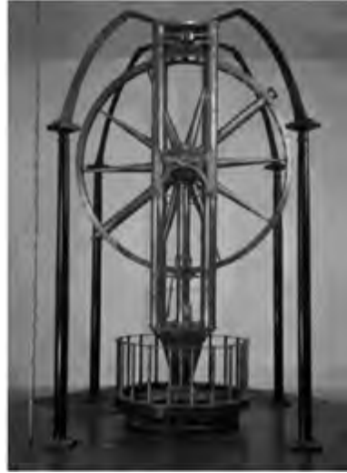
Рис. 12. Азимутальный круг Дж. Рамсдена, с помощью которого Дж. Пиаци открыл Цереру.
