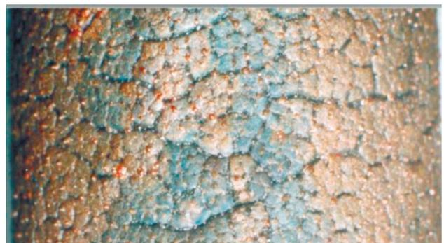
**Рис. 7.** Поверхность электрода плазмотрона после нескольких часов работы.
