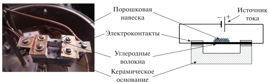
Рис. 2. Внешний вид и схема нагревательного элемента.
