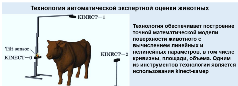
Рис.7. Модель автоматической фиксации характеристик экстерьера животного
