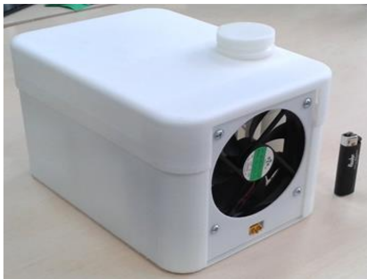
Рис. 9. Воздушно-алюминиевые топливные элементы, разработанные в Институте теплофизики СО РАН. Мощность 100 Вт. Сухой вес 1,9 кг. Время непрерывной работы 11-12 часов. Напряжение 14-24 В. Энергоемкость 1200 Вт ч. Удельная энергоемкость 300 Вт ч/кг
