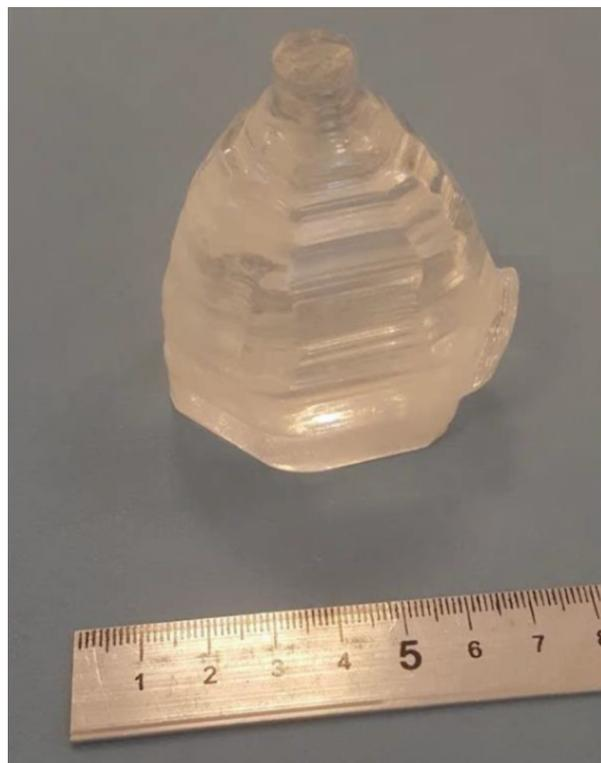
Рис. 1. Монокристалл вольфрамата лития, замещенный 15 мол. % молибдена.
