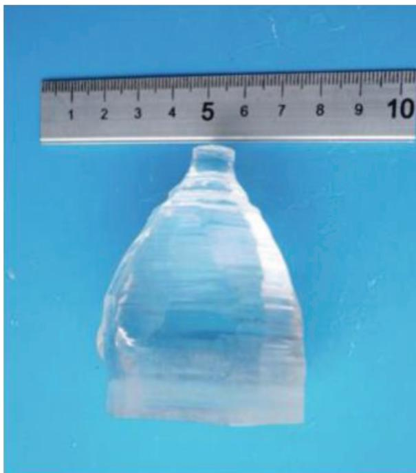
Рис. 2. Монокристалл вольфрамата лития, замещенный 10 мол. % молибдена.
