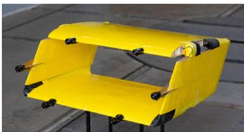
Рис. 20. Полноразмерная летающая модель – демонстратор технологий (размер крыла 1 м 10 см)
