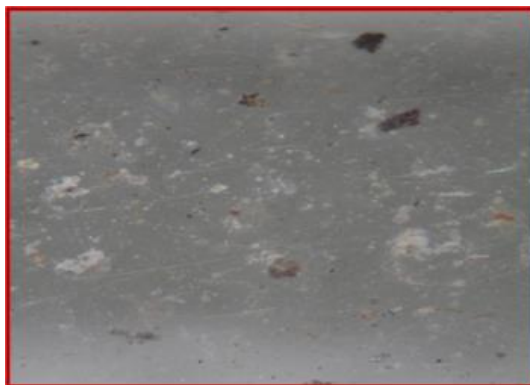
Рис. 45. Образец поликарбоната- не защищенный. Экспонирование на открытой площадке до 1 года. Наличие роста и развития микробной ассоциации.
