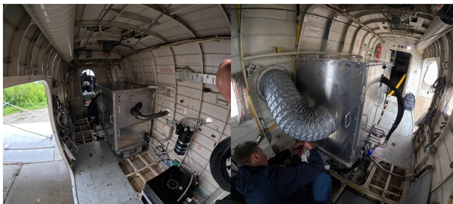
Рис. 40. Размещение Демонстратора энергетической установки на борту летающей лаборатории при проведении летных испытаний
