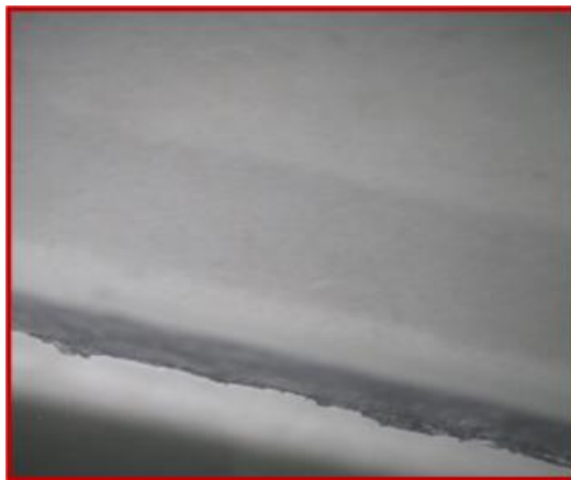
Рис. 44. Образец поликарбоната-защищенный покрытием. Экспонирование на открытой площадке до 1 года. Отсутствие жизнеспособных фрагментов микроорганизмов.
