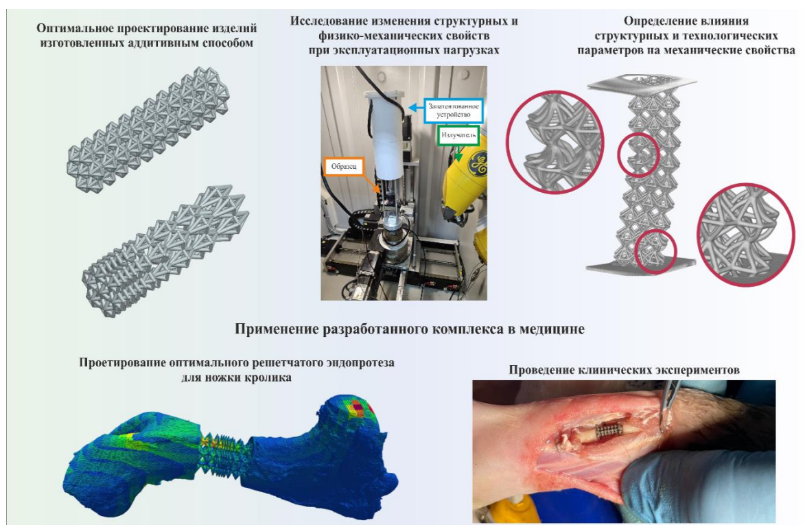
Рис. 6. Программно-аппаратный комплекс для проектирования и контроля структурных и физико-механических изменений изготовленных с помощью аддитивных технологий неоднородных изделий при эксплуатационных нагрузках
