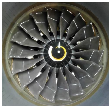
Рис. 37. Наземные испытания: «горячие» измерения движения и деформации лопастей винта самолета Ил-114-300 (а) и лопаток вентилятора авиационного двигателя ПД-14 (б)
