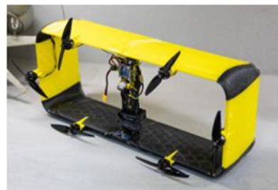
Рис. 21. Уменьшенная летающая модель для настройки автопилота (размер крыла 60 см)
