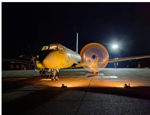
Рис. 37. Наземные испытания: «горячие» измерения движения и деформации лопастей винта самолета Ил-114-300 (а) и лопаток вентилятора авиационного двигателя ПД-14 (б)
