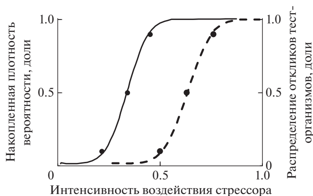
Рис. 1. Вероятностные точечные оценки отклика (в форме LC_{10} и LC_{50} ) на воздействие стрессора и показателя экспозиции стрессору на исследуемой территории [47]: сплошная линия – кумулятивная кривая плотности вероятности значений концентрации стрессора; пунктир – кривая доза-эффект.
