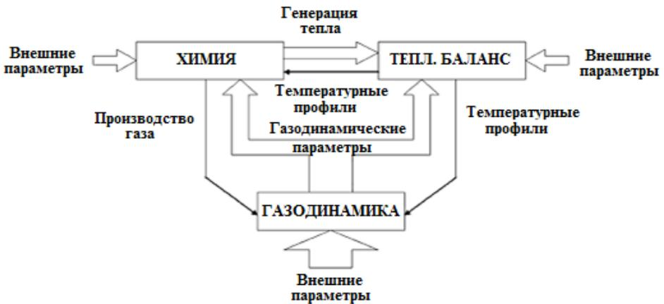
**Рис. 5.16.** Основные группы процессов, протекающих в реакторе с циркулирующим кипящим слоем [39]
