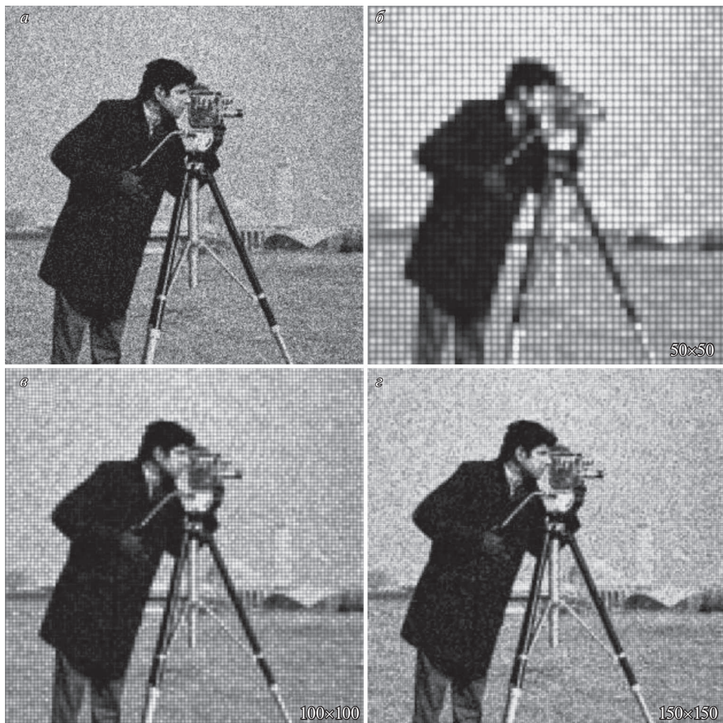
Рис. 4. Результаты кодирования–восстановления выборочного представления изображения “Самегаман”: a — выборочное представление размером 1 000 000 отсчетов как на рис. 2; б, в, г — восстановленные изображения, соответствующие сеткам в 50 \times 50 , 100 \times 100 и 150 \times 150 узлов.
