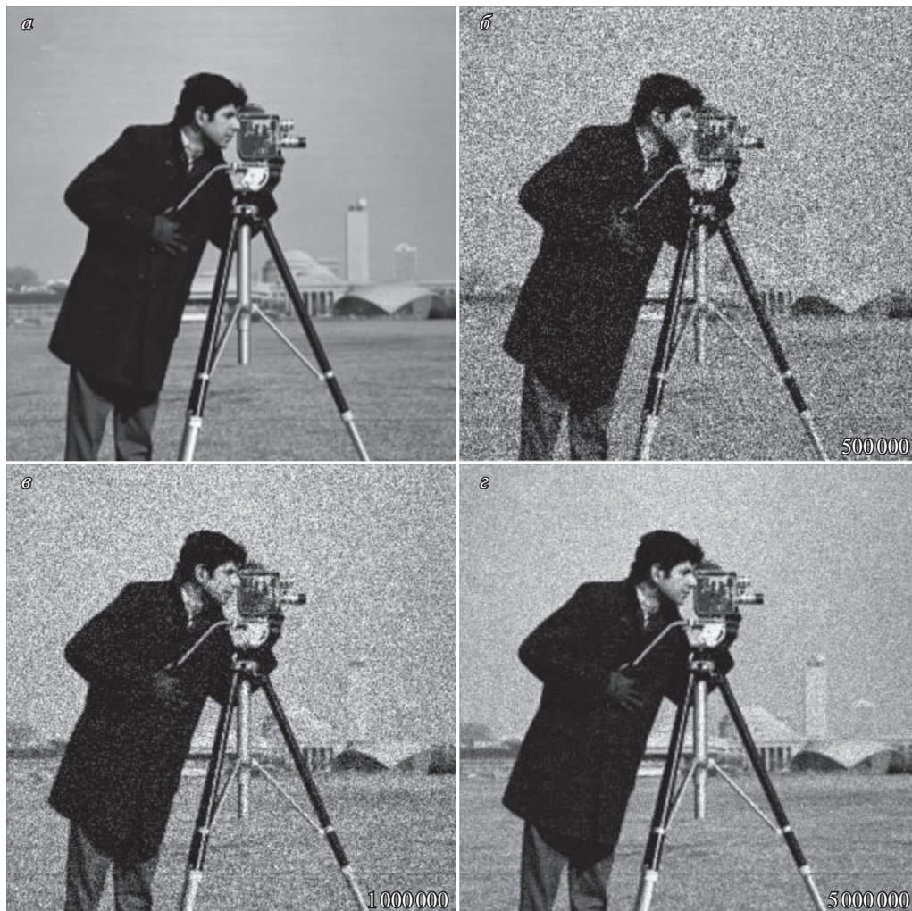
Рис. 2. Представление изображения “Cameman” выборками случайных отсчетов: a — исходное изображение в формате TIFF; б, в, г — представления выборками размеров, соответственно, 500 000, 1 000 000, 5 000 000 отсчетов.
