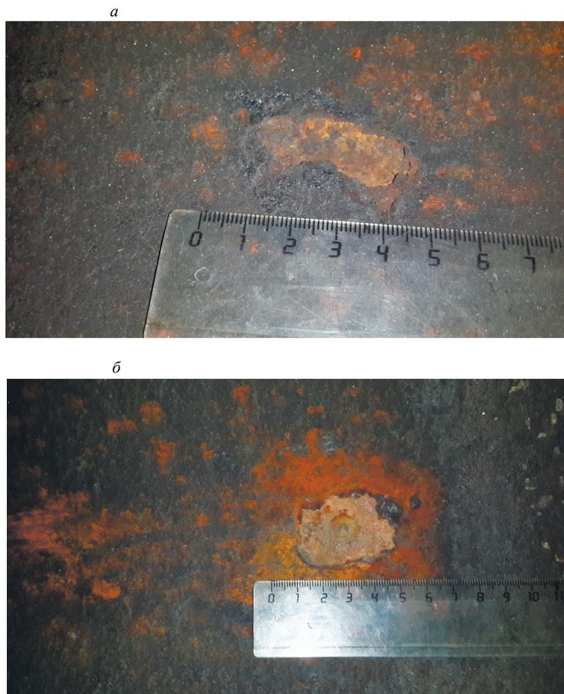
Рис. 1. Вид локальных дефектов разной формы на внутренней поверхности трубы после эксплуатации в условиях УКК.
