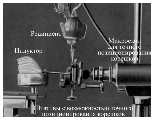
Рис. 1. Схема эксперимента по регистрации митогенетического излучения по его влиянию на деление клеток меристемы лука [5].
