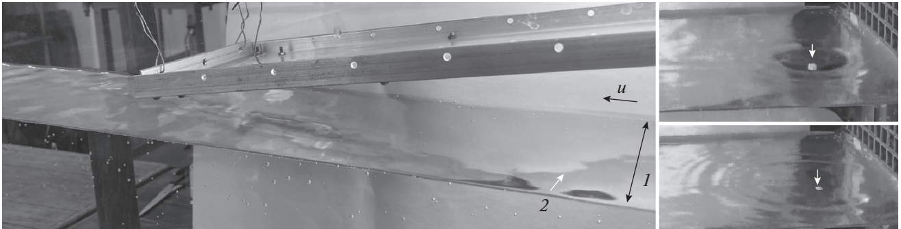
Рис. 2. Ускоряющийся поток воздуха под крышей: 1 – поверхность воды, 2 – край толстой части пленки (а). Вход в канал. Падение частицы на воду с пленкой (частица показана стрелкой) (б). Промежуток времени между кадрами равен 0.08 с.
