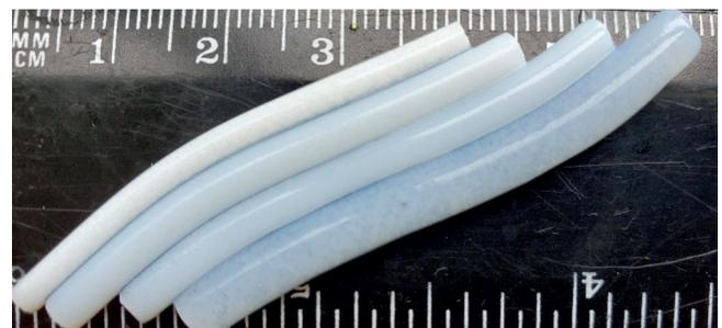
Рис. 2. Внешний вид композитных гидрогелей полиакриламид/ $\text{TiO}_2$ .
