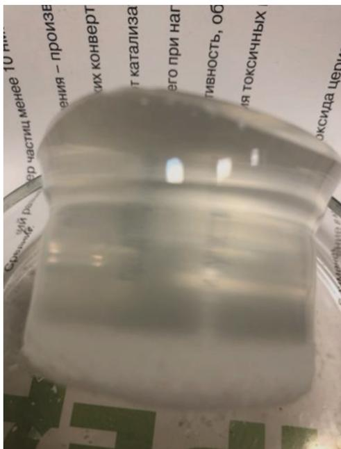
Рис. 1. Фотография монолитного образца ксерогеля (полимерного стекла) состава  $3\text{SiO}_2 \cdot 1.5\text{Al}_2\text{O}_3 \cdot n\text{H}_2\text{O}$ .
