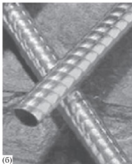
Рис. 4. (а) – Turbo-CAB (19 шт/дюйм), (б) – Korodense [67].
