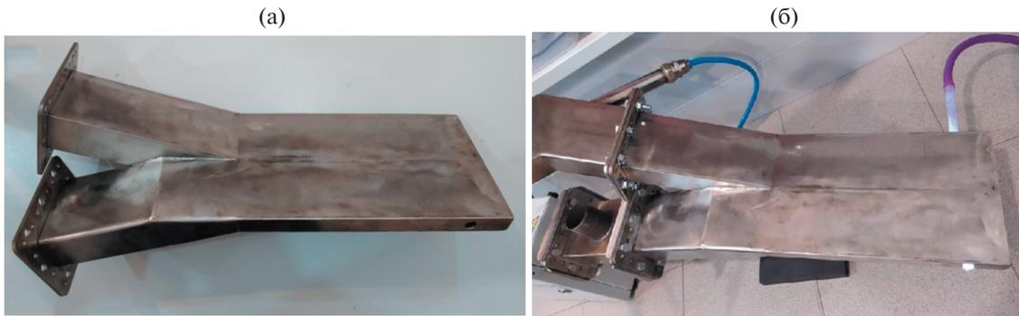
Рис. 3. Экспериментальная модель трехдецибелного волноводного Н-моста (а) и огневые испытания источника микроволнового барьерного разряда НТАП (б).
