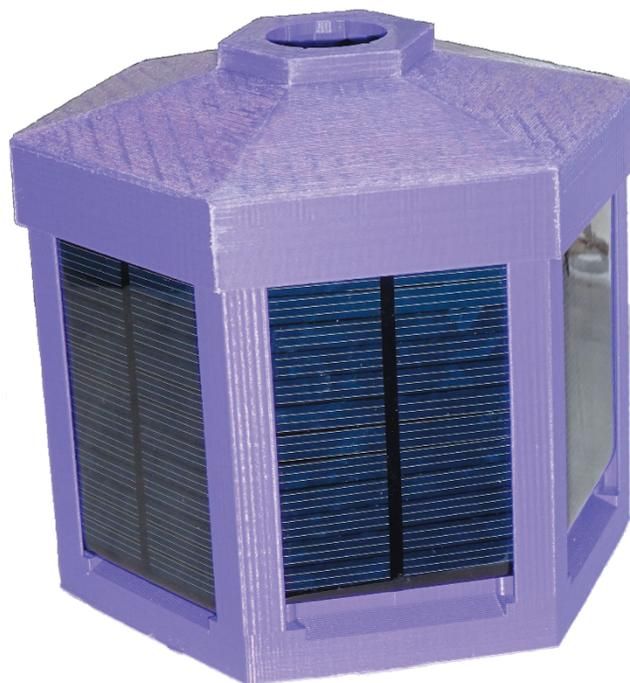
Рис. 2. Прототип корпуса модуля питания и связи.
