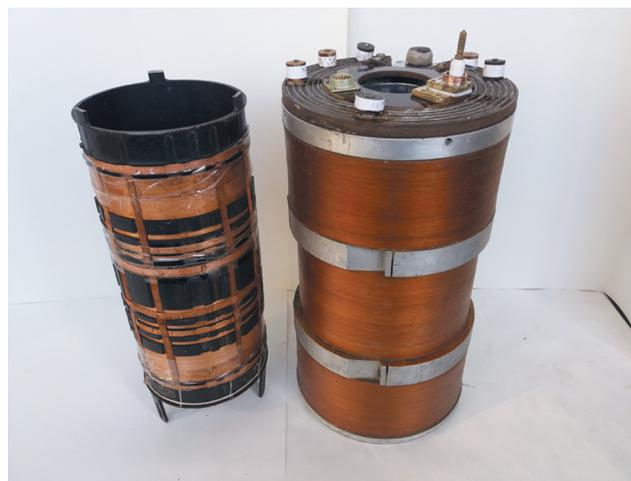
Рис. 1. Внешний вид с.п.с. и обмоток компенсации градиентов поля.
