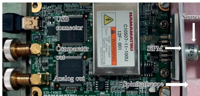
Рис. 1. Фотография использованного модуля MPPC с источником излучений.
