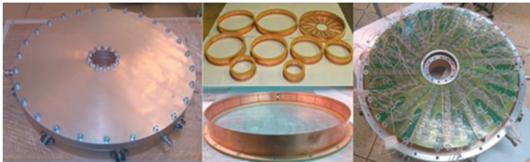
**Рис. 13.** Фотографии кольцевого двухкоординатного газового детектора для измерения малоуглового рассеяния тепловых нейтронов (слева), его электродной системы (в центре) и предусилителей (справа).
