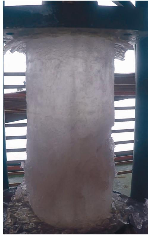
**Рис. 2.** Разрушение образца при испытании на одноосное сжатие в момент регистрации разрушающей (пиковой) нагрузки
