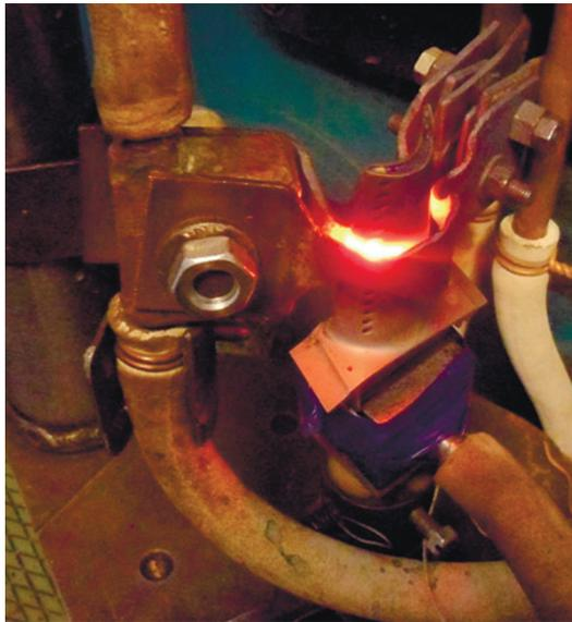
Рис. 1. Лопатка турбины и устройство индуктора при циклических испытаниях.
