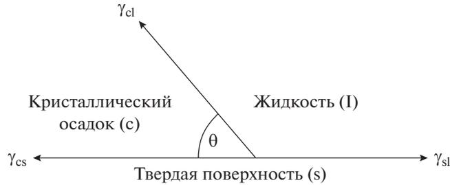
Рис. 3. Межфазное натяжение на границах между тремя фазами (две твердые фазы и одна жидкая).
