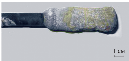
Рис. 2. Общий вид кремниевого осадка, полученного электролизом расплава \text{KCl--K}_2\text{SiF}_6\text{--SiO}_2 при i_k = 0.02 \text{ A/cm}^2 и T = 973 \text{ K} .
