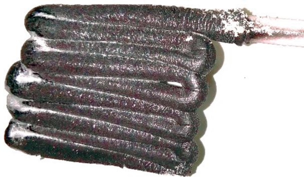
Рис. 2. Осадок на катоде после проведения эксперимента.
