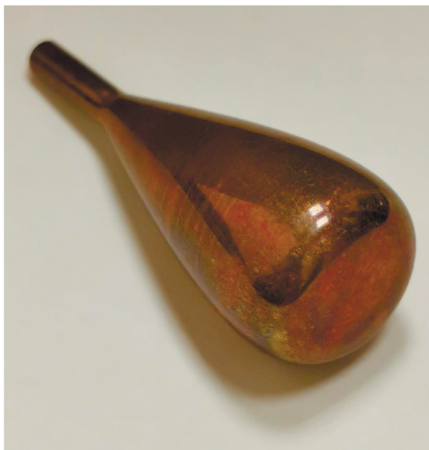
Рис. 4. Внешний вид электрода из меди.
