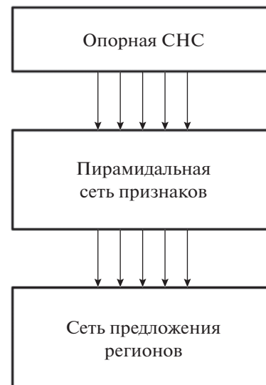
Рис. 3. Упрощенная схема архитектуры исследуемой системы обнаружения объектов на входном изображении.
