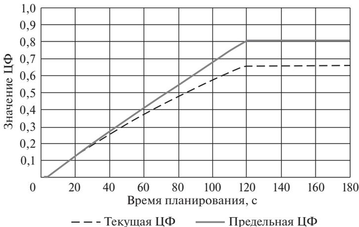
Рис. 4. Графики изменения значения текущей и предельной ЦФ в ходе планирования.
